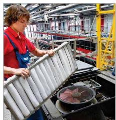
Fällt in der Bahn die Klimaanlage aus, kommt man schnell ins Schwitzen: Als Mechatroniker ist Dennis Kuhnert für deren Wartung zustän-
