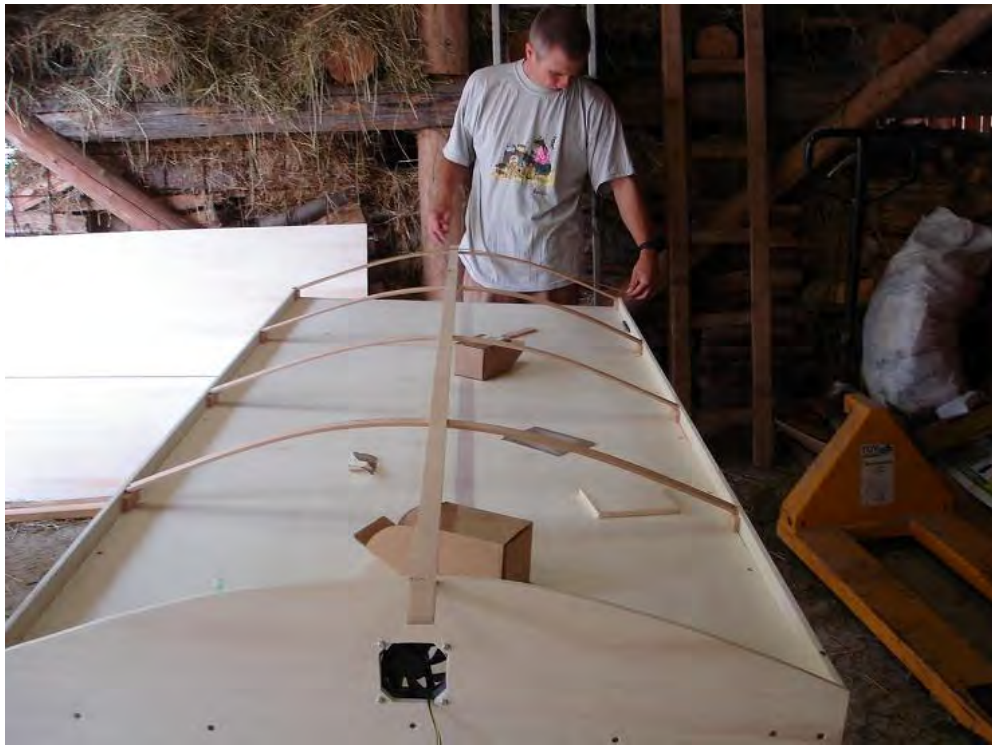
Fig 14 : Befestigen der Bogen
